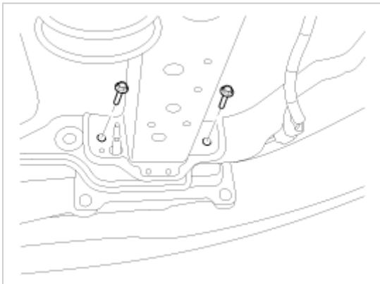
5. 拧下固定螺钉和卡扣，拆卸后保险杠 (A)。
